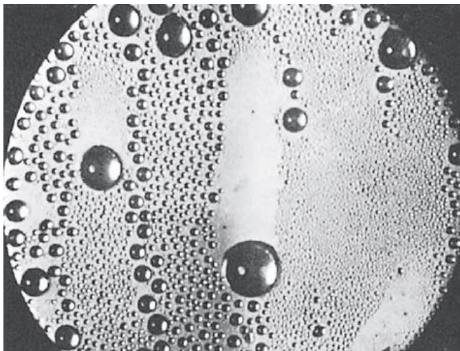
Rys. 1-1. Skraplanie kropłowe na pionowej powierzchni.
