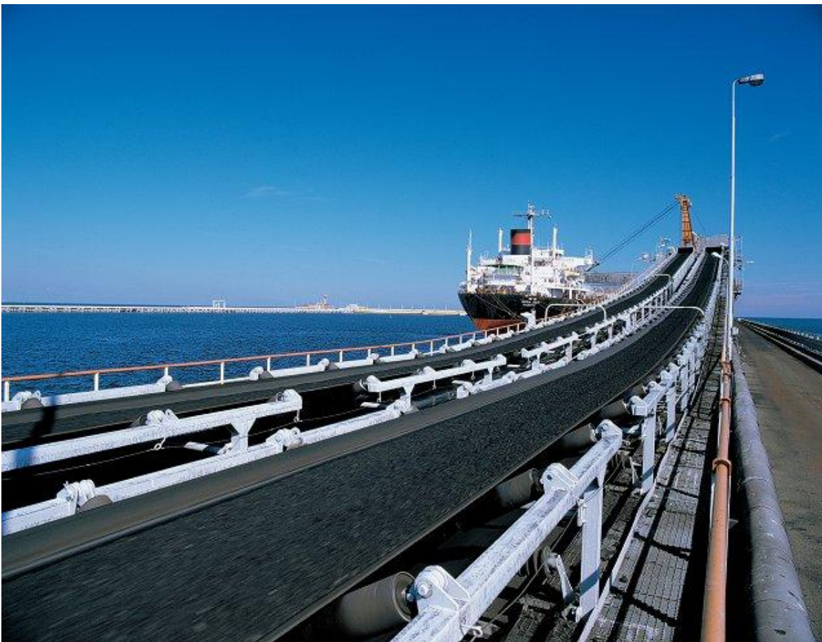
Zdj. Przenośniki taśmowe stałe nieckowe łamane
