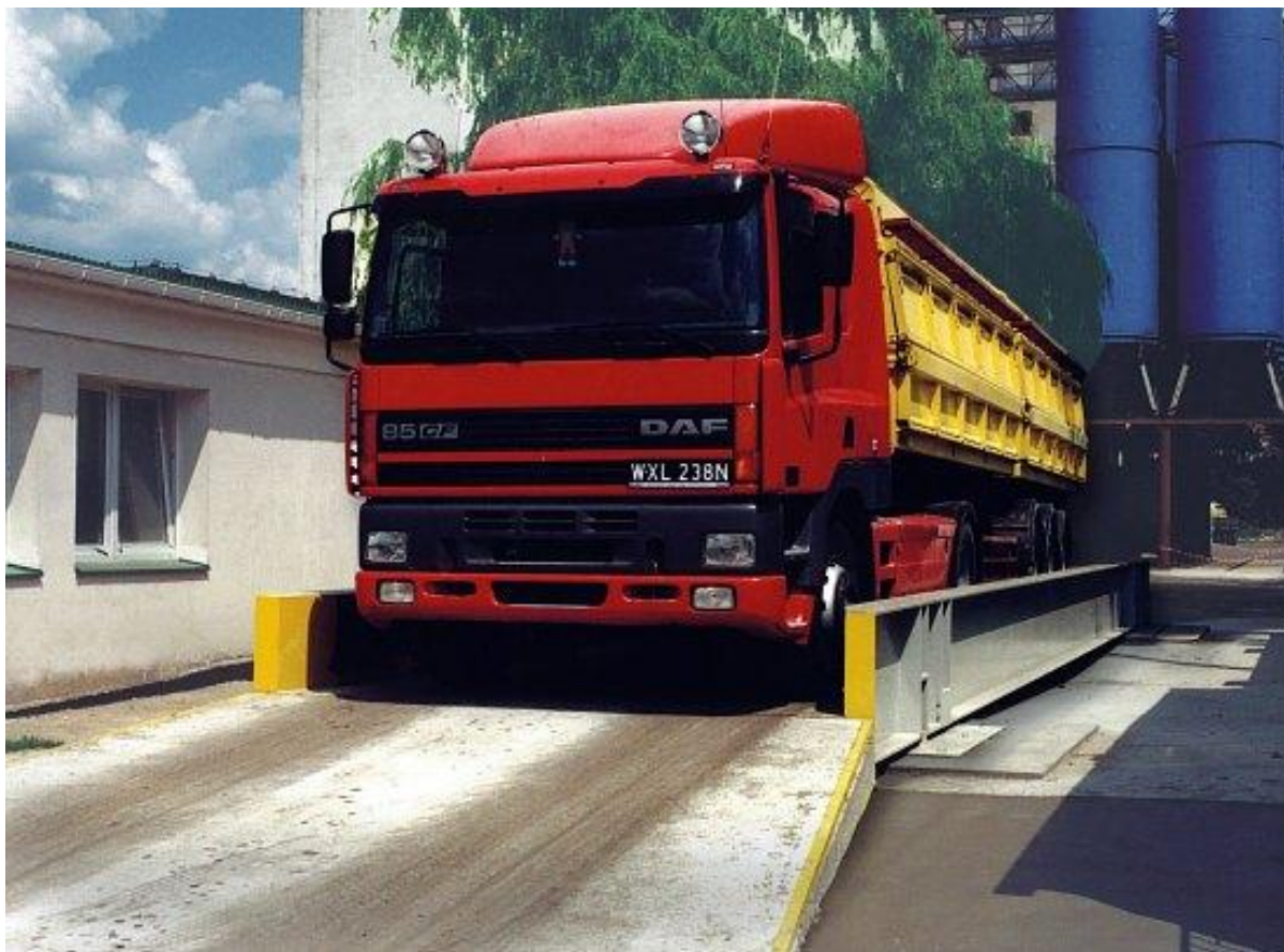
Zdj. Waga samochodowa pomostowa wyniesiona
