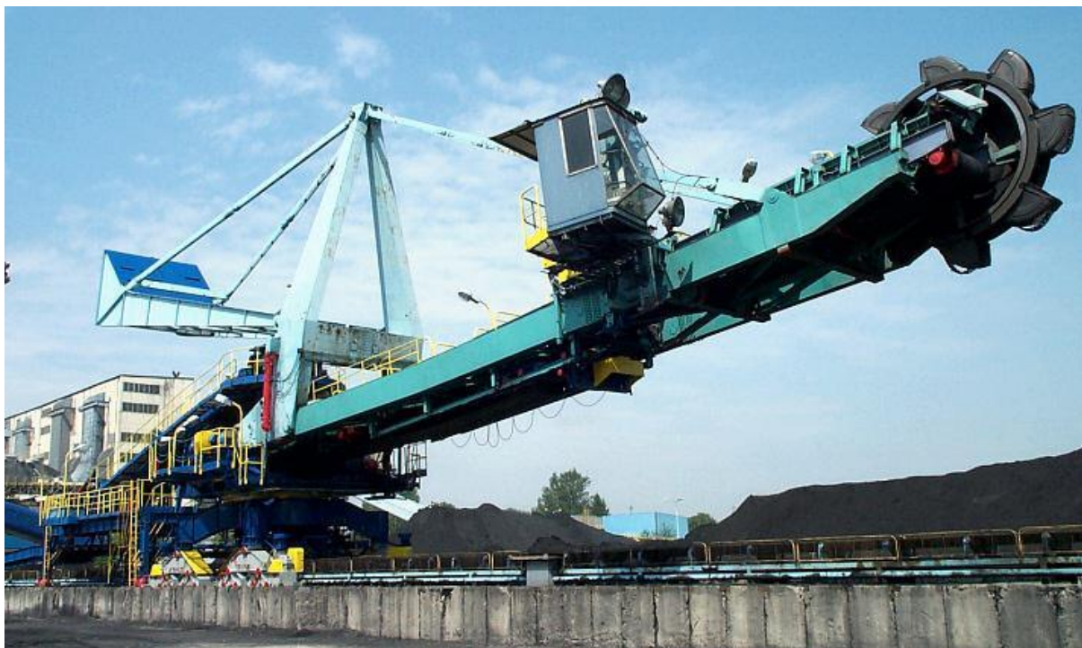
Zdj. Ładowarka kołowa szynowa o konstrukcji pełnej (niekratownicowej)
