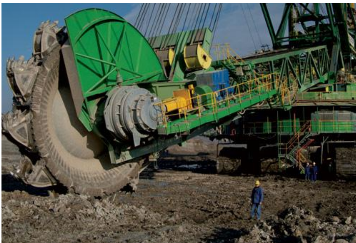
Zdj. Koło czerpakowe dużej ładowarki gąsienicowej
