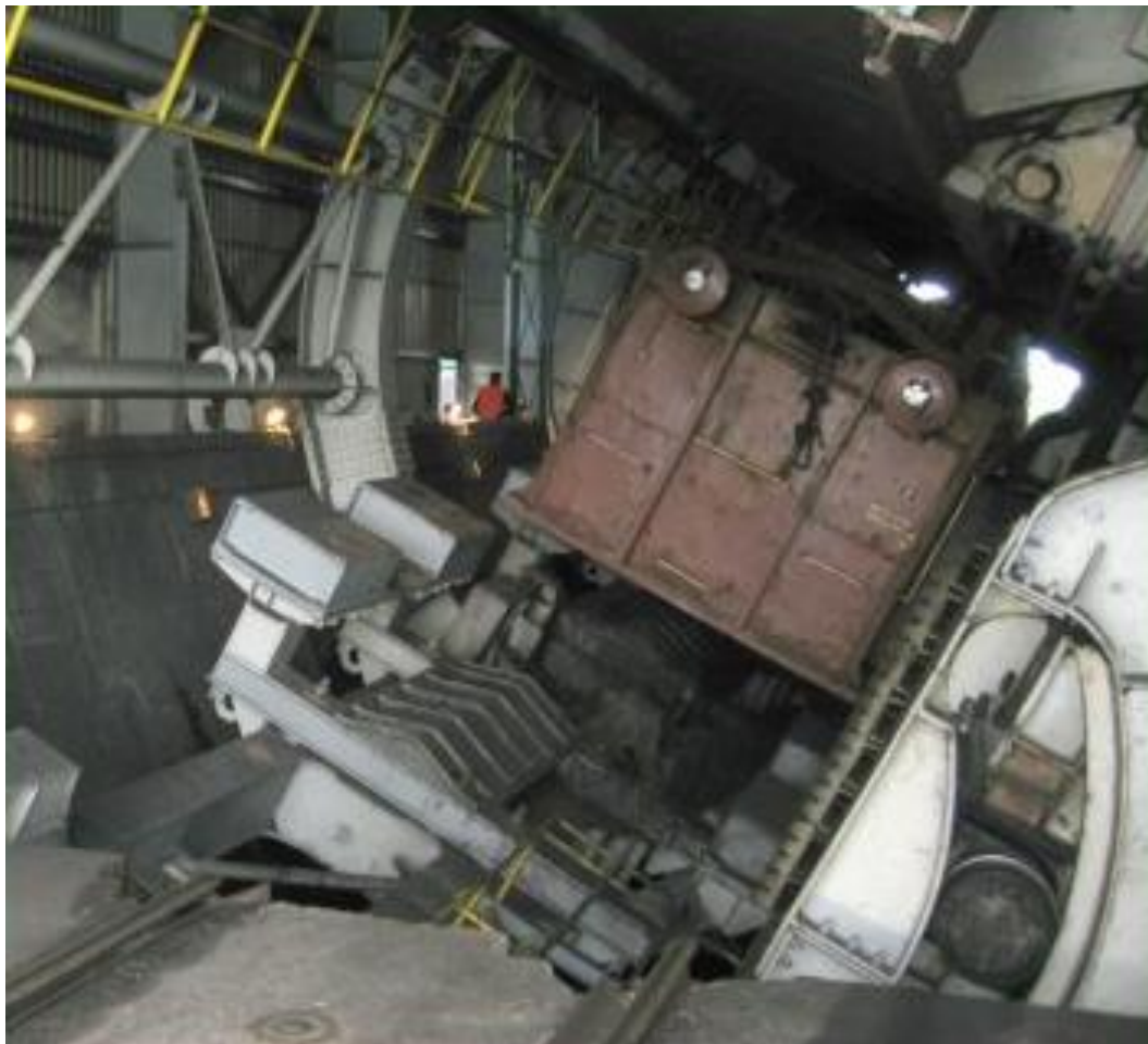
Zdj. Wywrotnica wagonowa boczna podczas pracy
