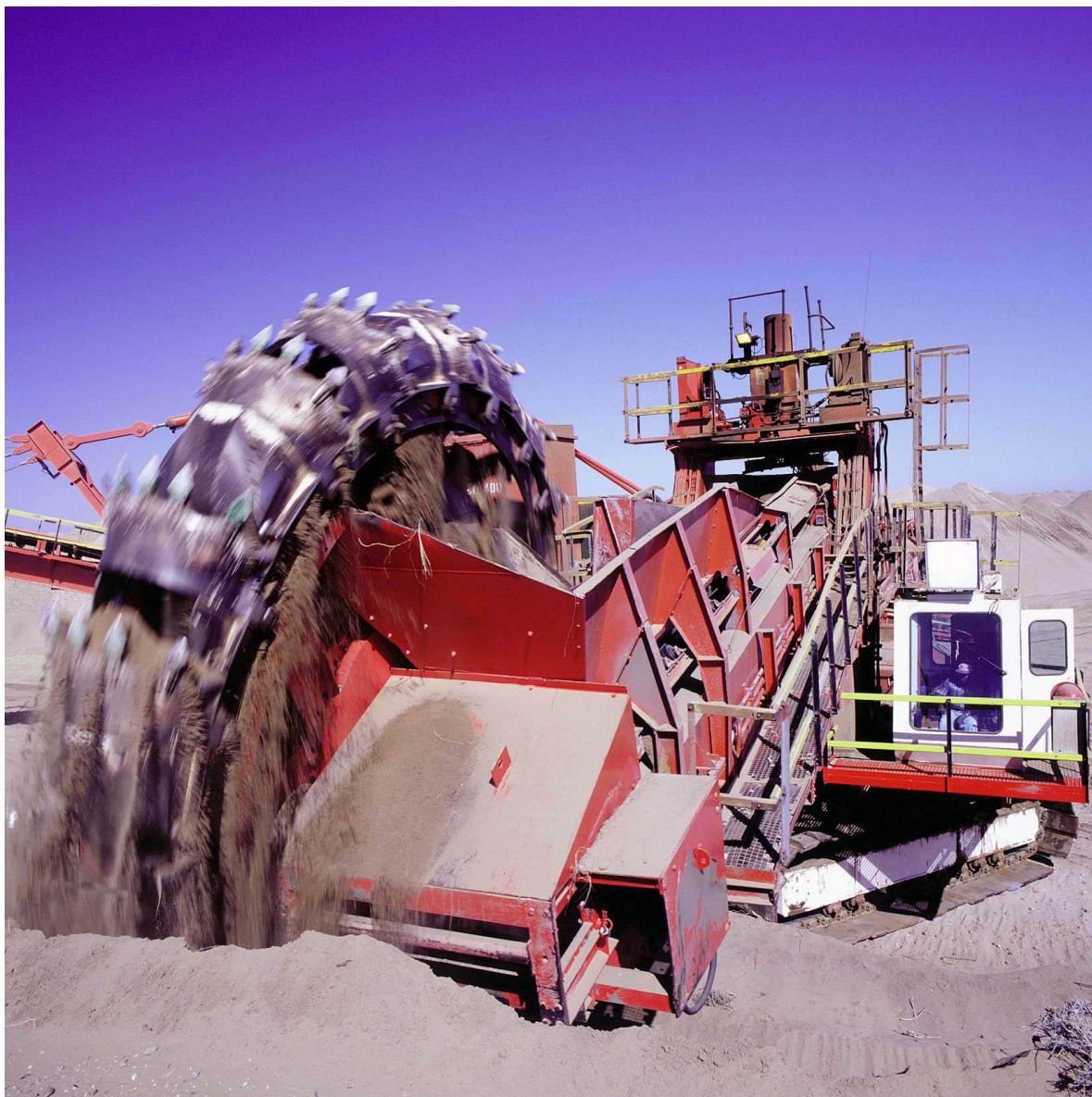
Zdj. Przekazywanie urobku z koła czerpakowego na przenośnik taśmowy
