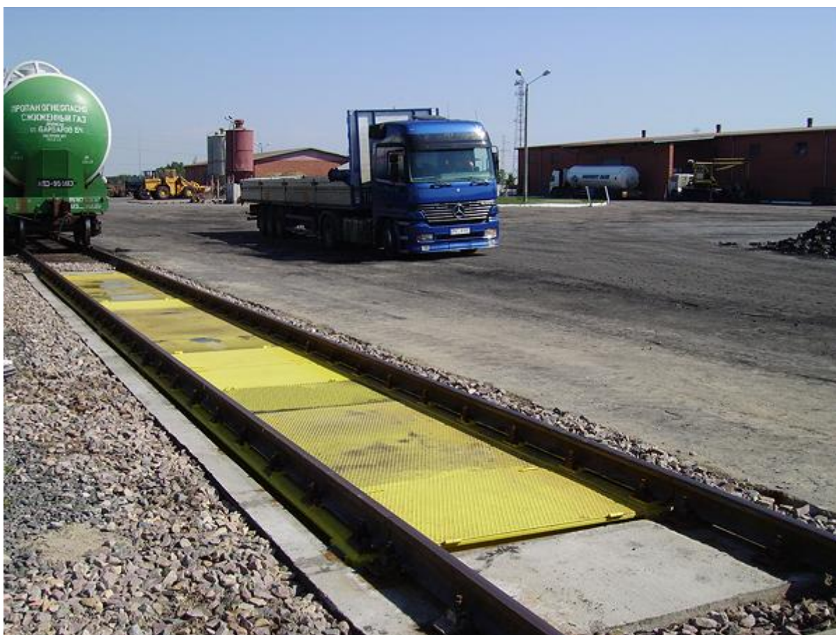
Zdj. Waga kolejowa pomostowa elektroniczna z przetwornikami tensometrycznymi
