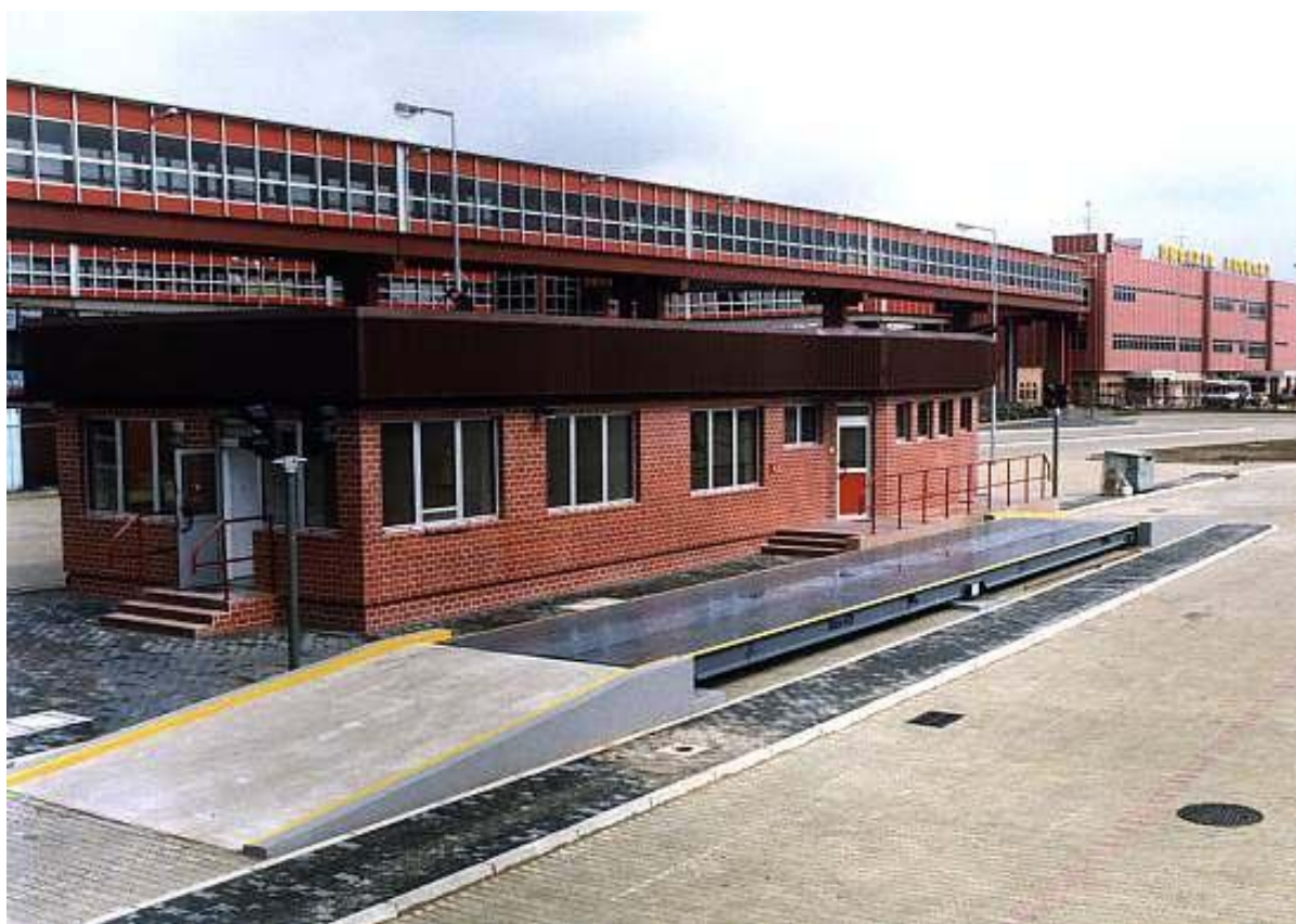
Zdj. Waga samochodowa pomostowa wyniesiona
