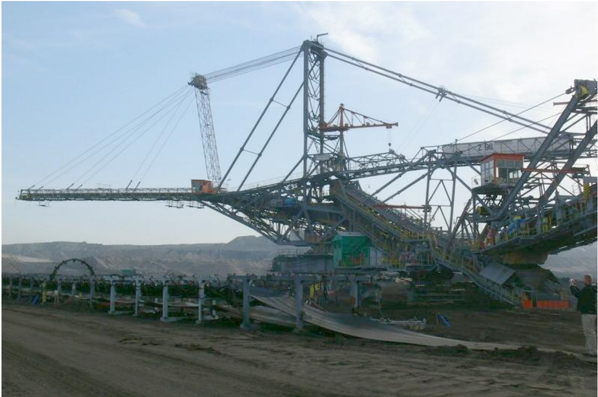
Zdj. Zwałowarka gąsienicowa współpracująca z linią przenośnika taśmowego
