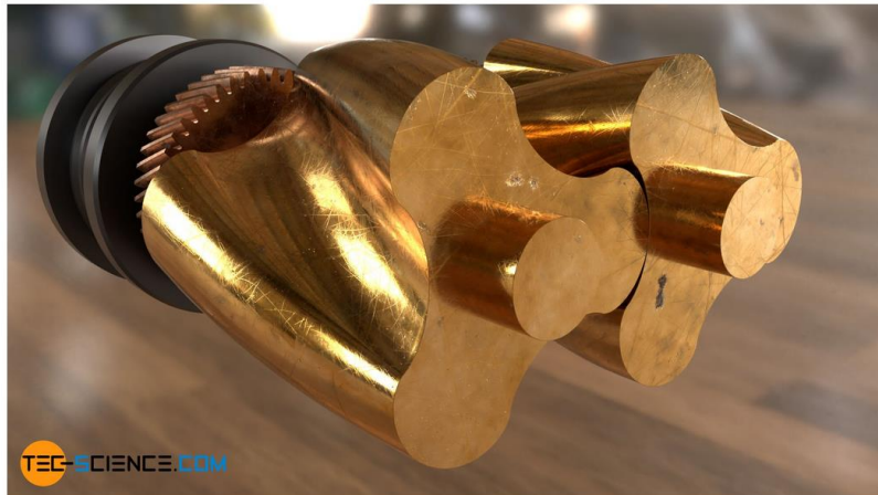
Rys. 3-11. Wirnik sprężarki Roots'a, trójłopatowej, ze skrzyżowanymi łopatkami.
